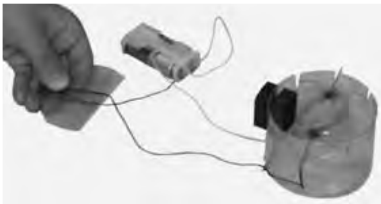
شکل ۶-۱۰ موتور الکتریکی ساده که توسط دانش‌آموزان ساخته شده است.
