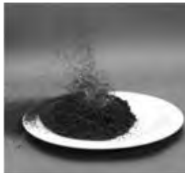
شکل ۵-۲- آمونیوم دی کرومات در اثر گرما تجزیه می‌شود و ضمن آزاد کردن نور و گرما، گاز تولید می‌کند. (گاز نیتروژن + بخار آب + کروم (III) اکسید → آمونیوم دی کرومات)
