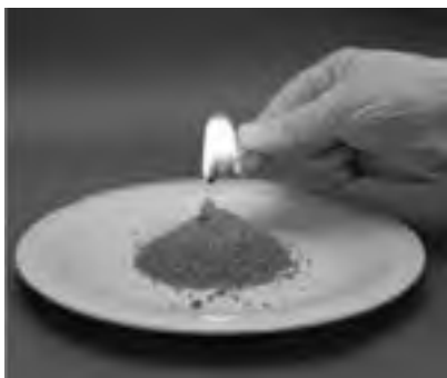
شکل ۵-۲- آمونیوم دی کرومات در اثر گرما تجزیه می‌شود و ضمن آزاد کردن نور و گرما، گاز تولید می‌کند. (گاز نیتروژن + بخار آب + کروم (III) اکسید → آمونیوم دی کرومات)
